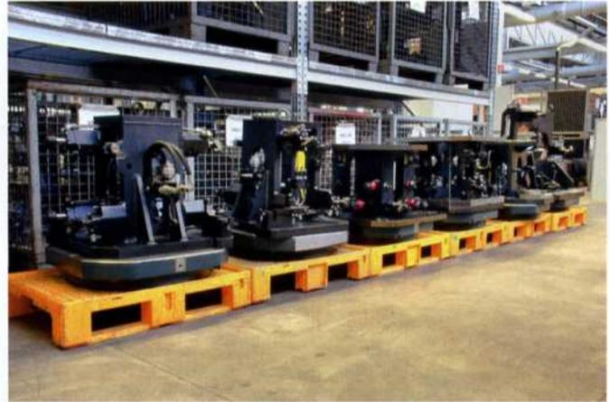
▲ In Wartestellung: AUMA-Vorrichtungen auf Grundplatten eines AMF-Nullpunktspannsystems
