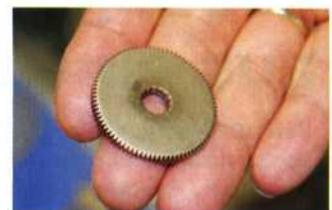
Weltneuheit: Bei dem Zahnrad ist das Verhältnis Modul zur Materialstärke von 1:8 und gleichzeitig ein sehr kleiner Stanzeinzug.
