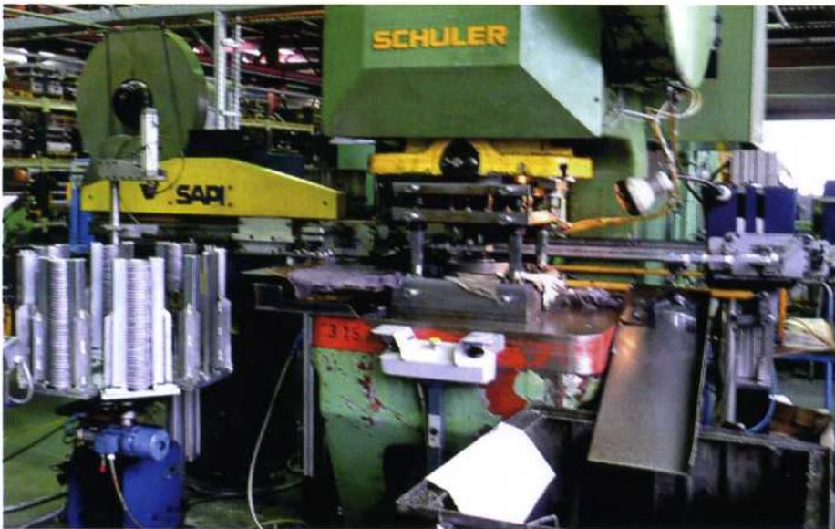
An dieser Stanzpresse werden die vorgestanzten Flanschrohlinge automatisiert und vereinzelt dem Stanzwerkzeug zugeführt.
