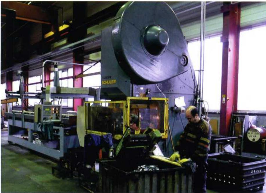
Eine von mehreren Stanzpressen der Marke Schuler. Diese wird über ein Streifenladesystem, das bei Carl Wüst selbst konzipiert wurde, mit Flachmaterial versorgt. Im anschließenden Stanzprozess entstehen dann die Präzisionsflansche.
