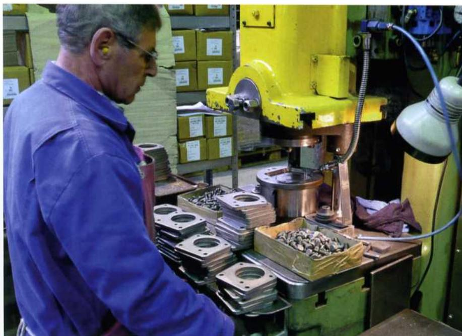
Von Carl Wüst werden einbaufertige Flansche an die Kunden geliefert, deshalb sind die Präzisionsflansche mit den entsprechenden Verbindungssystemen – zum Beispiel Schraubenbolzen – bestückt.
