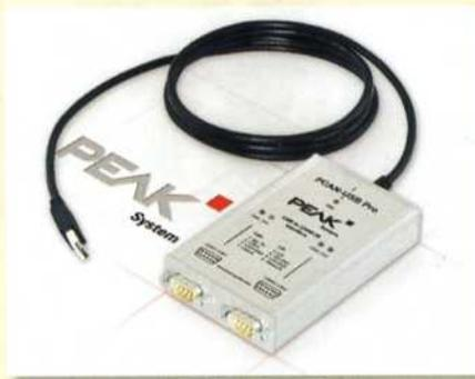
Peak-System Technik bietet den PCAN-USB Pro als neues Modul in der Serie der USB-Adapter an. Es handelt sich um einen High-Speed-USB-Adapter mit zwei D-Sub-Steckverbindungen für die Anbindung eines Computers an CAN- und LIN-Netzwerke. Es können gleichzeitig zwei Feldbusse nach Wahl angeschlossen werden, mit entsprechenden Adapterkabeln auch bis zu vier (2 x CAN, 2 x LIN). Der Adapter wird über eine USB-Verbindung
