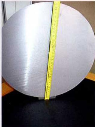
Mit der neuen Diamantdrahtsäge der HK Präzisionstechnik GmbH kann mit einem bisher unvorstellbar hohen Vorschub im Trockenverfahren gesägt werden.
