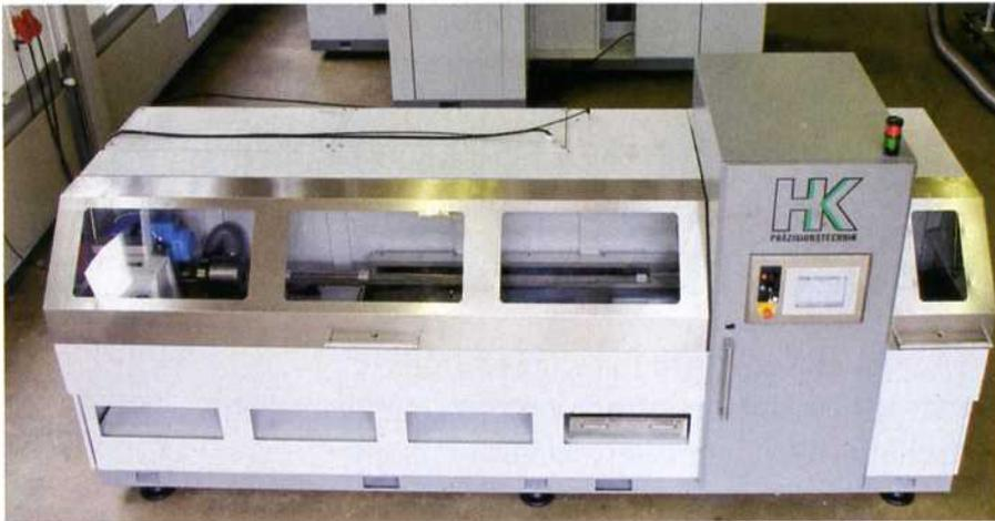
Bild 2: Die Diamantdrahtsäge mit neuer Sägetechnik arbeitet im Trockenverfahren.
