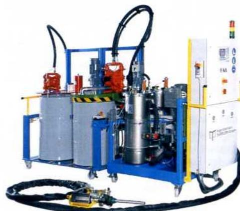
**Wirtschaftliche Verarbeitung der Reaktionsharze: modulares Nodopur VS AR-System für das vollautomatisierte Mischen und Dosieren von Polyurethan- und Epoxidharzen**
