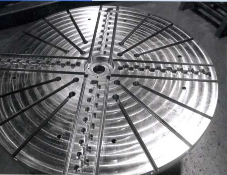
Übergroße: Der Stahlwerkstoff Toolox 33, hier bei einem Werkzeugisch, ist auch für große Werkstückdimensionen verfügbar. Bild: SSAB
