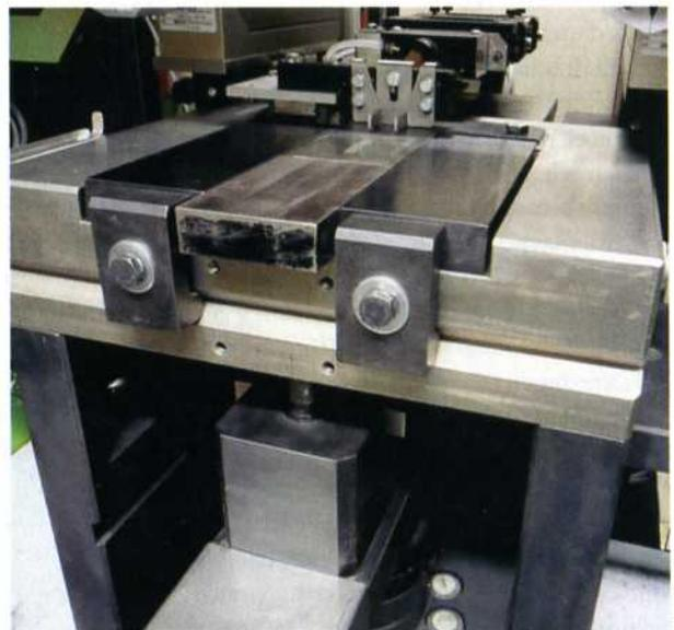
Bild 2: Kompakte Rahmenkonstruktion. Darin ist die Hydraulik integriert. Die Maßgenauigkeit entspricht der im Werkzeugbau.
