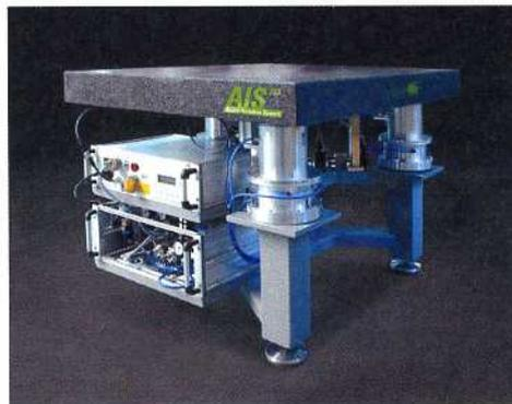
hochdynamische Mess-, Prüf- und Produktionsmaschinen von mechanischen Störkräften. Das System mit bis zu sechs geregelten Freiheitsgraden arbeitet in Echtzeit und steuert ungewollten Maschinenbewegungen entgegen. So lassen sich selbst ohne aufwendige Implementierung von Feedforward-Signalen kurze Taktzeiten fahren und Settling Times im Millisekunden-Bereich realisieren. Anwender freuen sich über höheren Durchsatz, grössere Zuverlässigkeit und sichere Wiederholbarkeit.
