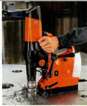
Kernbohren spart im Vergleich zum Spiralbohren bis zu 40 Prozent der benötigten Arbeitszeit.
