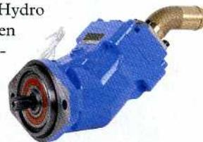
Die Axialkegelkolbenpumpen XA von Hydro Leduc wurden speziell für Anwendungen im LKW-Bereich, zum direkten Anflanschen auf SAE Pumpenantriebe entwickelt. Die extrem kompakte Bauweise erleichtert die Installation auf dem Fahrgestell. Der Dauerbetriebsdruck geht bis 350 bar und kann 400 bar als Spitzenwert betragen. Die Pumpen sind besonders für die Anwendung mit Absetz- und Abrollkipper geeignet. Alle Baugrößen besitzen 7 Kolben für ruhige Laufeigenschaften und minimale Pulsation. (qui)
