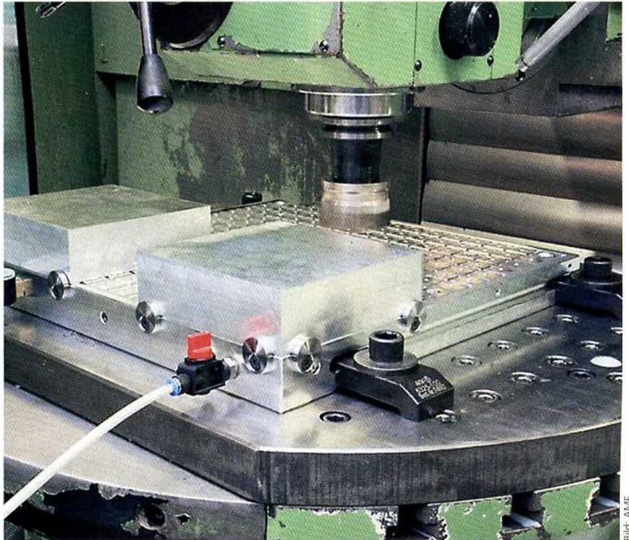
Das Vakuum-Spannsystem kann sowohl mit Druckluft – und das ohne externe Venturidüse – als auch mit einer Vakuumpumpe betrieben werden.
