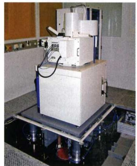
**Bild 2:** Isolierung von Bodenschwingungen bei einem Elektronenstrahlmikroskop. Die Lösung ist eine Stahlplatte mit unterbautem Isoliersystem.
