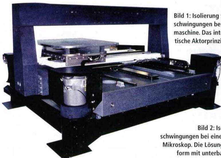
**Bild 1:** Isolierung von Bodenschwingungen bei einer Präzisionsmaschine. Das integrierte pneumatische Aktorprinzip im Maschinenunterbau ermöglicht eine Entkopplung bis hinab in den Niederfrequenzbereich.
