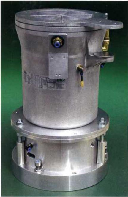
**Bild 3:** Der pneumatische Aktor umfasst eine Membran- und eine Horizontal-luftfeder. Aufgabe ist die Isolierung horizontaler und vertikaler Schwingungen.
