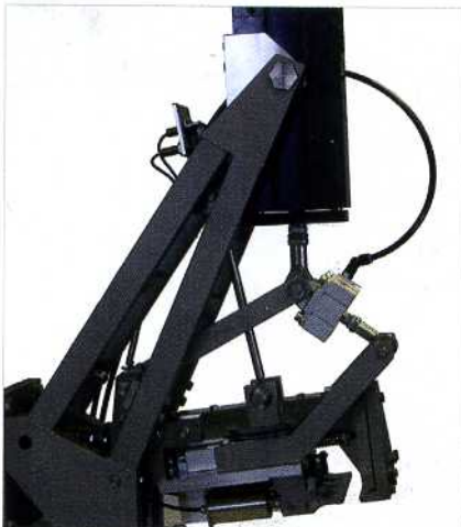
Neues funktionsfertiges Ultraschall-Schweißsystem SUP-Top-Seal-Modul der Telsonic AG. Es lässt sich flexibel in teil- und vollautomatisierte Verpackungslinien integrieren.
