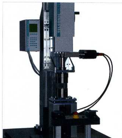
Bei der neuen Torsionaltechnologie von Telsonic schwingt die Sonotrode nicht mehr longitudinal, sondern torsional, was eine geringere Belastung der Teile zur Folge hat. (Fotos: Telsonic)
