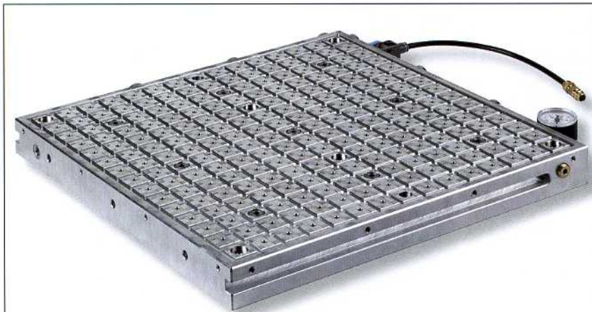
Bild 1: Die neue Vakuum-Spanntechnik ermöglicht eine verzug- und schwingungsfreie Fünf-Seiten-Bearbeitung von vorwiegend dünnwandigen, nichtmagnetischen Teilen bei nur einer Aufspannung
