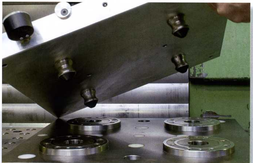
Bild 4: Das neue Vakuum-Spannsystem lässt sich zusammen mit dem Nullpunktspannsystem Zero-Point für noch rationelleres Wechseln der Platte kombinieren (Werkbilder: Andreas Maier, Fellbach)
