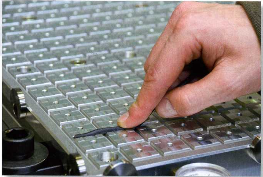
Bild 3: Mit einer Feldereinteilung im 25 mm-Raster sowie Nutenzügen, die abgedichtet werden, ermöglicht das neue Vakuum-Spannsystem die flexible Positionierung von Werkstücken
