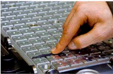
Flexible Positionierung: Die Grundplatte des neuen Vakuum-Spannsystems macht es möglich.
