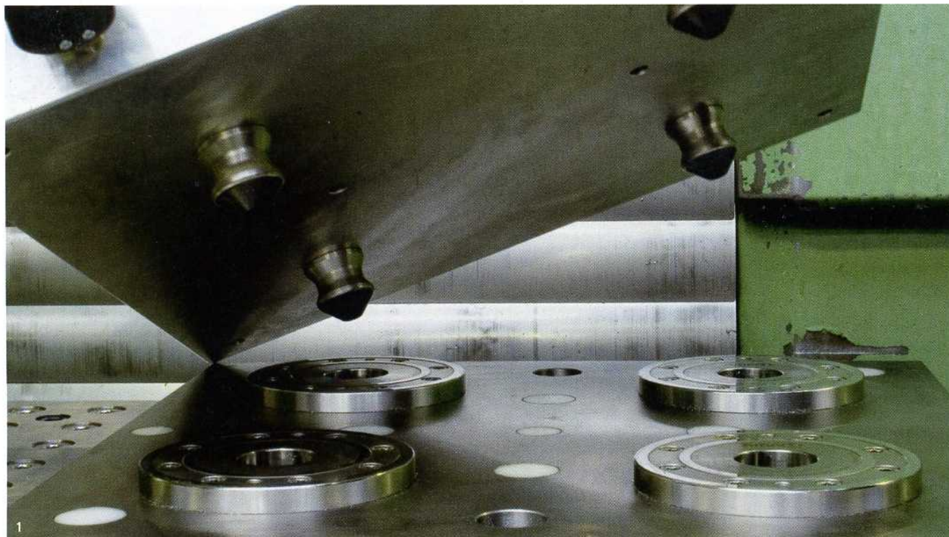
1 _ Das Vakuum-Spannsystem lässt sich mit dem AMF-Nullpunkt-Spannsystem Zero-Point für noch rationelleren Plattenwechsel kombinieren. 2_ Mit einer Feldeinteilung im 25-mm-Raster sowie abdichtbaren Nutenzügen ist die flexible Positionierung von Werkstücken möglich.
