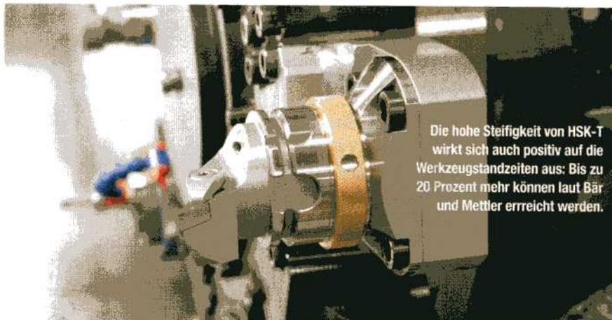
Die hohe Steifigkeit von HSK-T wirkt sich auch positiv auf die Werkzeugstandzeiten aus: Bis zu 20 Prozent mehr können laut Bär und Mettler erreicht werden.
