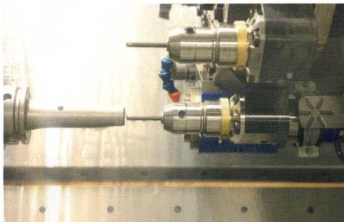
„Vor allem beim Bohrungsdrehen von kleinen Durchmessern in gehärteten Werkstücken ist die hohe Stabilität der Swiss-Flex HSK-Schnittstelle auf der Hardinge Maschine optimal“, so Herdegen
