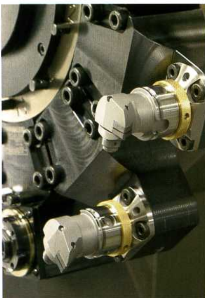
Bild 5: Mit der Spanneinheit HSK und einem dazu passenden Halter können auf dem Revolver der Drehmaschine zwölf Werkzeuge in definierter Nullstellung vorgehalten werden
