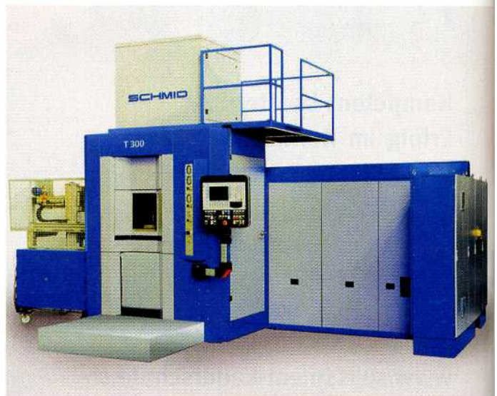
Die Taumelpresse mit 3000 kN Presskraft benötigt lediglich 5 Sekunden für ein Kegelrad, die Verzahnung ist danach in der Endkontur.
