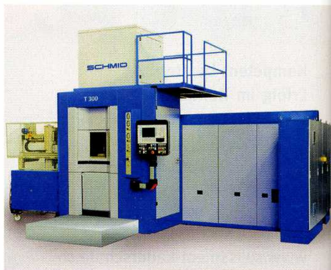
Die Taumelpresse mit 3000 kN Presskraft benötigt lediglich 5 Sekunden für ein Kegelrad, die Verzahnung ist danach in der Endkontur.
