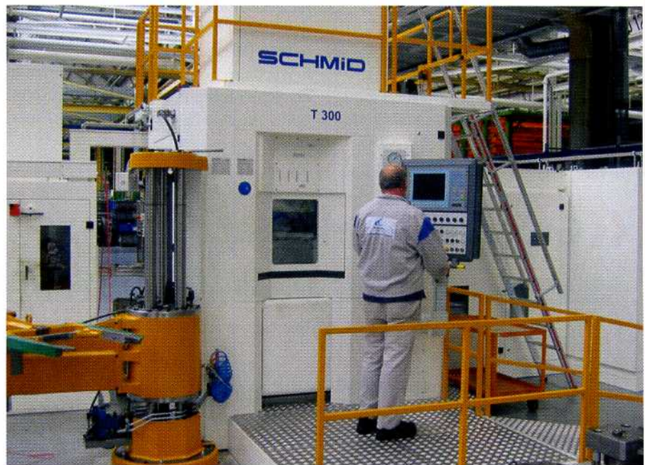
Die Einführung der Taumeltechnik zur Herstellung von Differenzialkegelrädern wurde bei Volkswagen von einem Expertenteam unterstützt und sorgfältig geplant.
