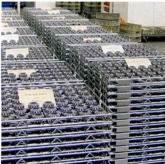
Rund 20000 Kegelräder der täglich produzierten 44800 werden im Taumelverfahren auf Schmid-Pressen hergestellt.
