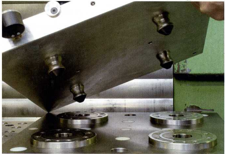
Das Vakuum-Spannsystem lässt sich zusammen mit dem Nullpunktspannsystem Zero-Point von AMF für noch rationelleres Wechseln der Platte kombinieren.
