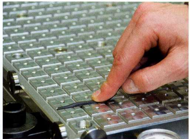
Mit einer Feldereinteilung im 25 mm-Raster sowie Nutenzügen, die abgedichtet werden, ermöglicht das neue Vakuum-Spannsystem die flexible Positionierung von Werkstücken.
