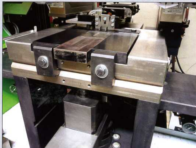
Der von Bott konstruierte Rahmen mit der integrierten Hydraulik
