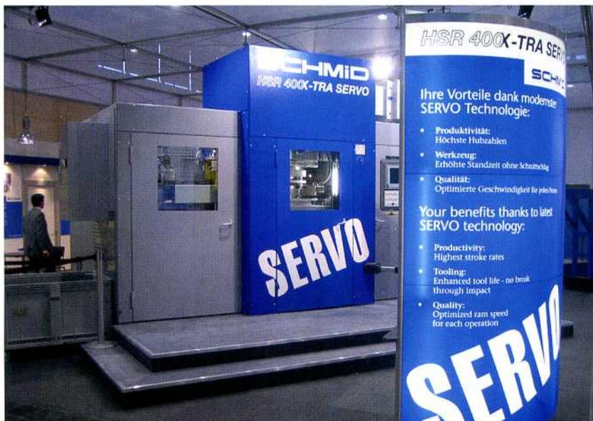
Bild 2: Mit Servotechnologie zum Weltrekord. Die neue Feinschneidpresse HSR 400 X-TRA produzierte mit 105 Hüben pro Minute auf der Messe
