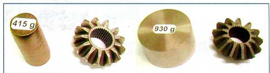
3 Das Einsatzgewicht des geschmiedeten Rohteils beträgt beim Taumelverfahren mit 415 g weniger als die Hälfte – 2000 Tonnen Stahl werden jährlich eingespart
