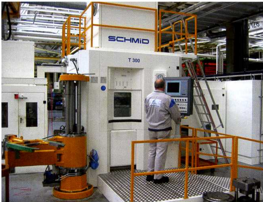
1 Die Einführung der Taumeltechnik zur Herstellung der Differenzialkegelräder wurde bei Volkswagen sorgfältig geplant
