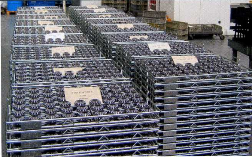
2 Rund 20 000 Kegelräder werden im Taumelverfahren auf Schmid-Pressen hergestellt
