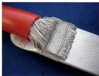
Fahrzeug Zug um Zug auf Aluminiumleiter umgestellt. Den Anfang machen starre Flach- und flexible Rundleitungen mit größeren Querschnitten. Die Aluminiumleitungen von der Batterie zum etwa 4,5 m
