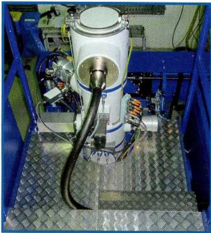
Der Elektronenstrahlgenerator verfügt über eine Leistung von 12 kW und die neueste Ablenktechnik.
