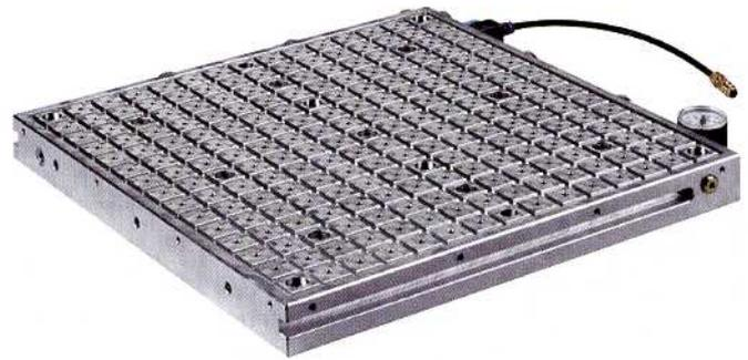
Die neue Vakuum-Spanntechnik ermöglicht eine verzugs- und schwingungsfreie Fünf-Seiten-Bearbeitung von vorwiegend dünnwandigen, nichtmagnetischen Teilen bei nur einer Aufspannung.
