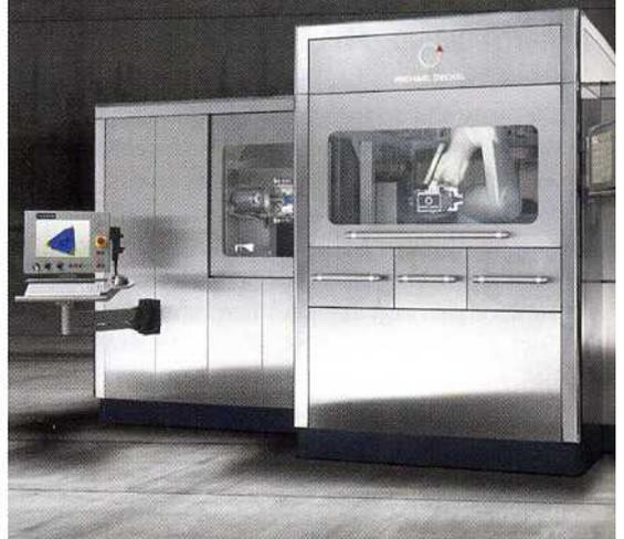
In der Automatisierungszelle erledigt ein vor Kühlmittel geschützter Roboter die Beladung, den Werkstück- und Schleifkörperwechsel sowie individuell programmierbare Nebenfunktionen.
