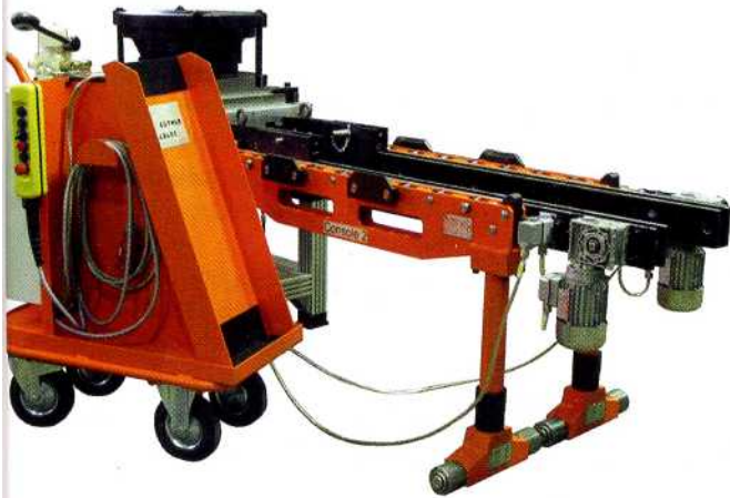
Die nachrüstbare Verschiebeeinheit von Güthle für den einfachen und schnellen Wechsel von Press- und Stanzwerkzeugen
