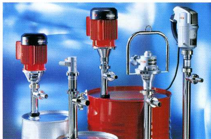
Abb. 2: Flux Dickstoffpumpen mit Exzentrerschneckentechnik werden vor allem benötigt für das Ab- und Umfüllen von viskosen Substanzen ab etwa 300 mPas. Sie sind ausgelegt auf die Förderung sehr hoch viskoser, noch fließfähiger Substanzen bis 20.000 mPas.
