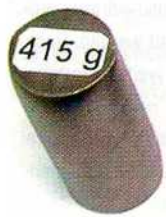
Der Materialeinsatz beim Fertigen von Kegelrädern mittels Taumelverfahren (links) ist deutlich geringer als beim Zerspanen (rechts). VW spart dadurch jährlich rund 2000 t Stahl. Bilder: VW
