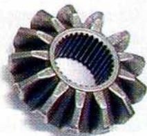
Der Materialeinsatz beim Fertigen von Kegelrädern mittels Taumelverfahren (links) ist deutlich geringer als beim Zerspanen (rechts). VW spart dadurch jährlich rund 2000 t Stahl. Bilder: VW
