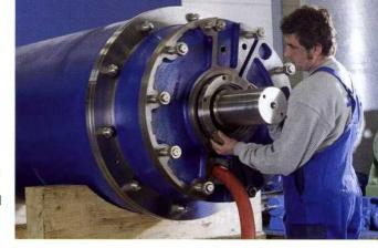
Bild 3: Ritz Pumpen baut den weltweit ersten sechspoligen Unterwassermotor mit 13 kV und 2.800 kW (3.700 PS/HP).
