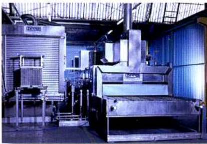
Bild: Kammeranlage im Durchlaufverfahren (Werkbild: Zippel GmbH & Co. KG, Neutraubling)
