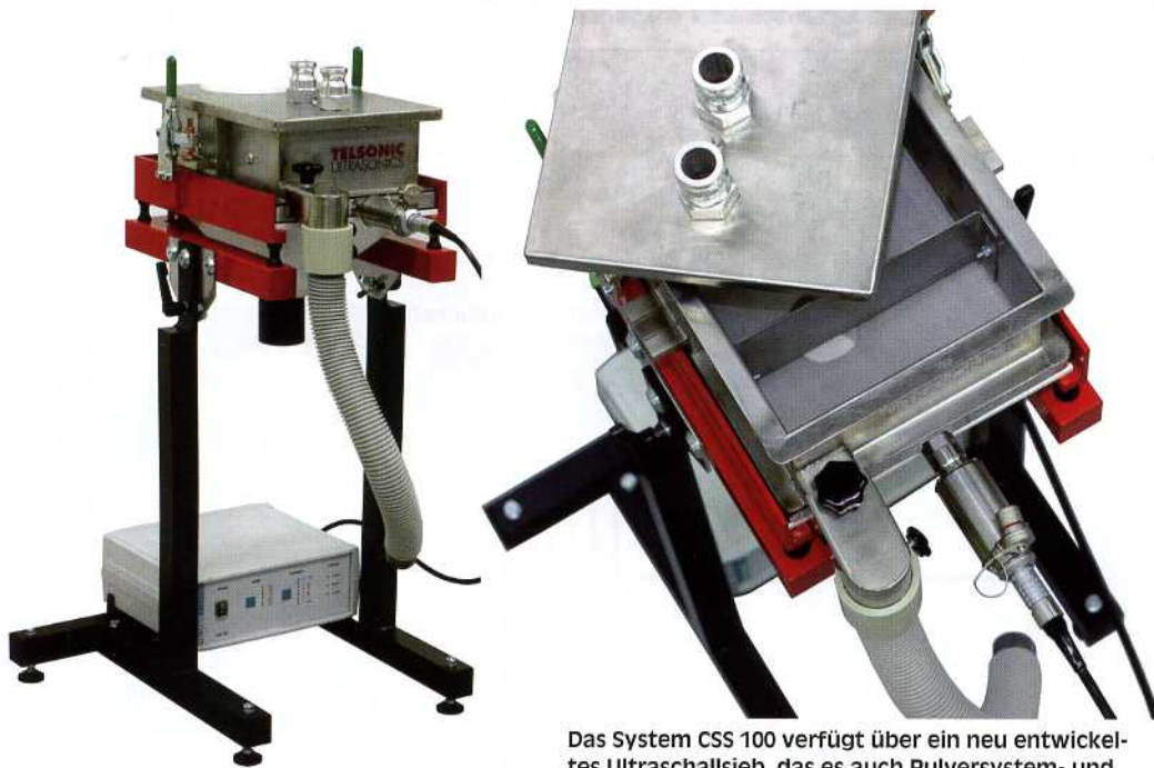
Ultraschall-Pulversiebssystem CSS 100. Generator, Konverter und Ringresonator sorgen für deutliche Produktivitätssteigerungen.
