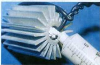
Hochtemperatursensoren, Gas- oder Wassermesser sowie eine Vielzahl elektrischer Komponenten halten im Keramikschutz Temperaturen von bis zu 16500 °C stand. Der Werkstoff zeichnet sich neben seinen Materialeigenschaften insbesondere durch die einfache Herstellung und Verarbeitung aus. Das weiße, überwiegend aus Siliziumoxid bestehende Pulver wird im richtigen Mischungsverhältnis – ideal sind 100 Gewichtsteile Pulver zu 18 bis
