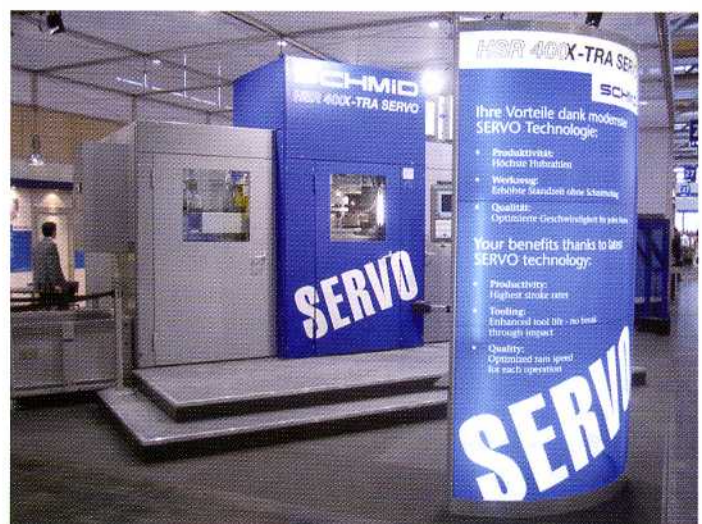
Mit Servotechnologie zum Weltrekord. Die neue Feinstschneidpresse HSR 400 X-TRA produzierte mit 105 Hüben pro Minute auf der Messe.
