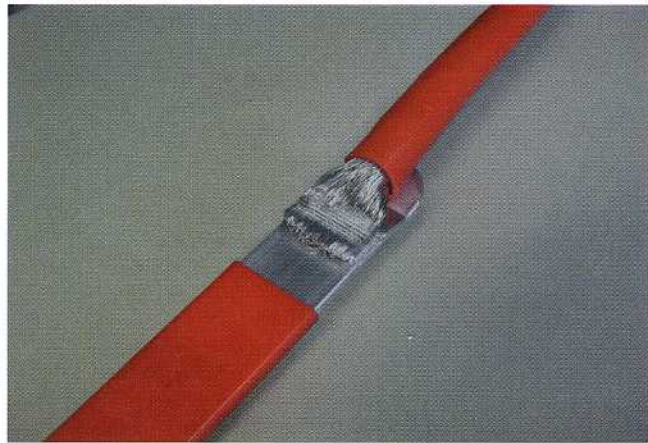
Der Übergang von starrer Aluminium-Flachleitung zu flexibler Aluminium-Rundleitung ist mit Ultraschall-Schweißtechnik von Telsonic als reine intermetallische Verbindung realisiert.
