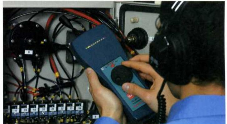
Dank moderner Ultraschallmessgeräte finden Sie Lecks schnell und effizient.
