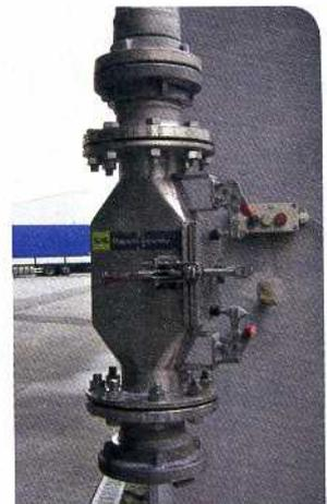
**Rohrmagnet entfernt kleinste Eisenverunreinigungen.**
