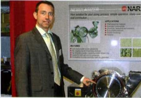
Der Nara Nebulizer optimiert Granulate hinsichtlich ihrer Größenverteilung, wie Marketingleiter Olaf Schüller erklärt. Diese Standardisierung ist mit feuchten sowie trockenen Granulaten durch das besondere Mahlprinzip in kontinuierlicher Weise möglich. Dabei werden die oberkörnigen Agglomerate in ihrer Größe reduziert und gleichzeitig feinkörnige- bzw. Staubpartikel auf größeren Agglomeraten aufgebracht. Eine anschließende Siebung ist nicht mehr erforderlich.
