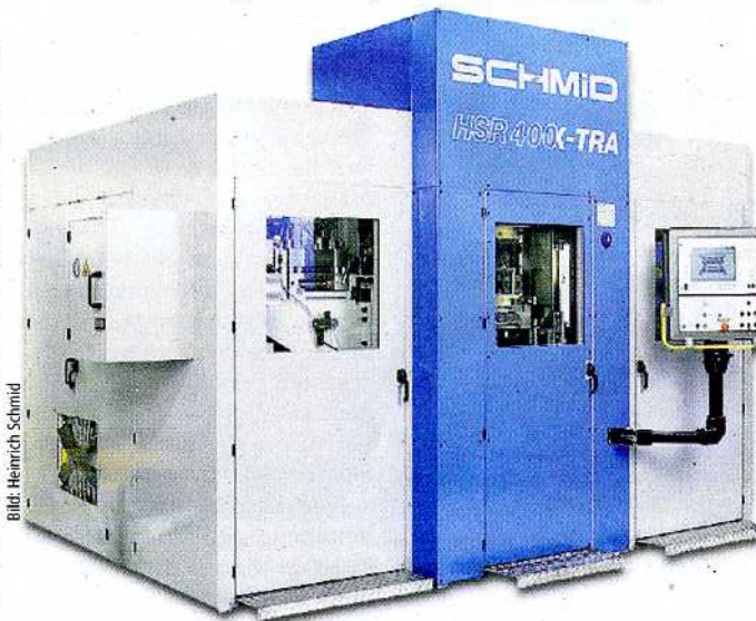
Die neue Feinschneidpresse HSR 400 X-TRA mit 4000 kN Presskraft. Dank Servotechnologie kann die Geschwindigkeit im gleichen Hub verschiedenen Fertigungsprozessen entsprechend optimiert geregelt werden.
