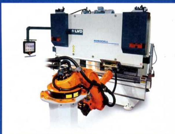
Eine kostengünstige Alternative zu den High-End-Roboterbiegezellen soll die Robocell von LVD sein.
