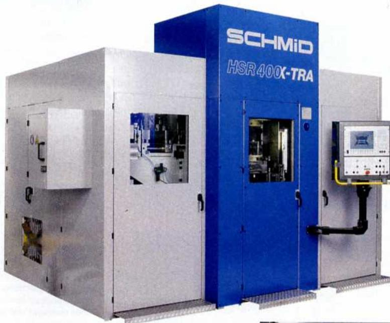
Die neue Feinschneidpresse HSR 400 X-TRA mit 400 kN Presskraft. Die Servotechnik kann die Geschwindigkeit im gleichen Hub verschiedener Fertigungsprozessen entsprechend optimiert geregelt werden.
