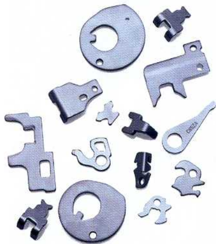
Komplexere Bauteile durchlaufen nach dem Feinschneiden weitere Bearbeitungsprozesse.
