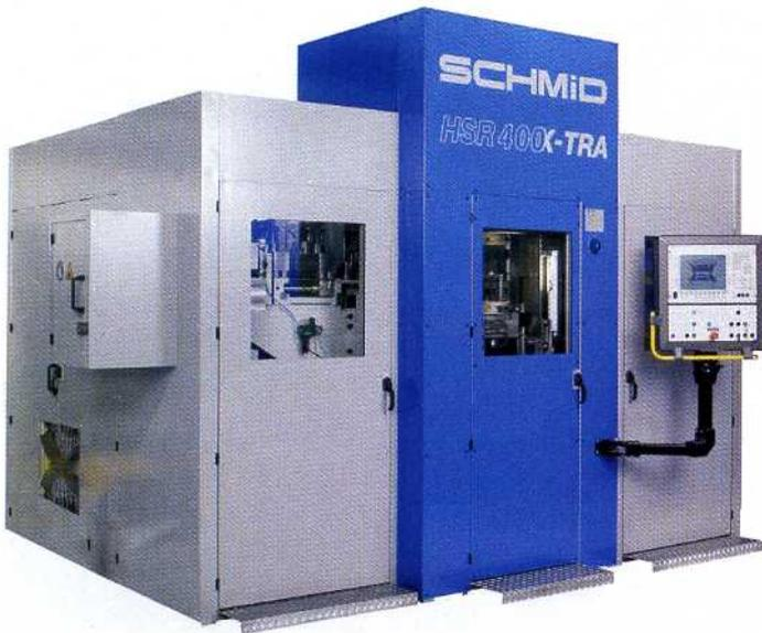
Die neue Feinschneidpresse HSR 400 X-TRA mit 4.000 kN Presskraft.
