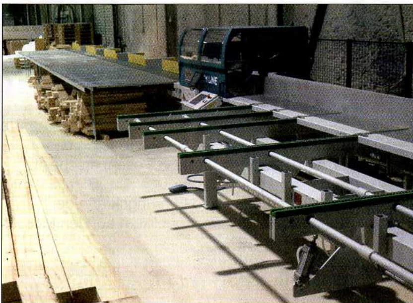
Kappanlage „Slim Line 225“ zum Holzzuschnitt bei einem Niedernberger Verpackungsbetrieb. Foto: Christof Reinhardt Maschinenbau
