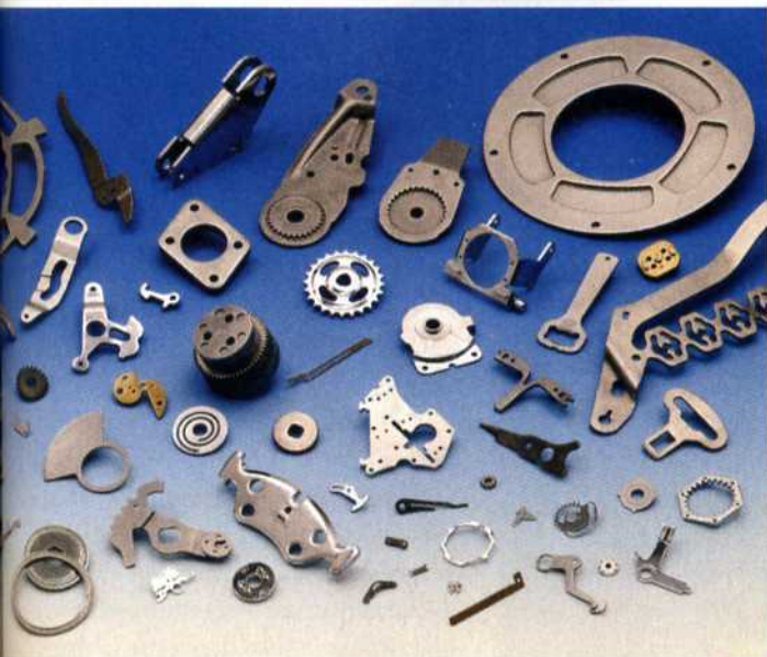
Bild 1: Mit dem Feinschneidverfahren lassen sich Metallteile im Stanzverfahren hochpräzise und in großen Serien herstellen.
