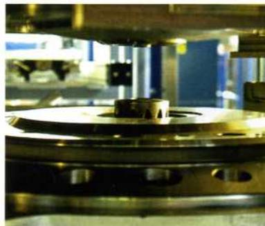
Automatische Zuführung der Schmiederohlinge
